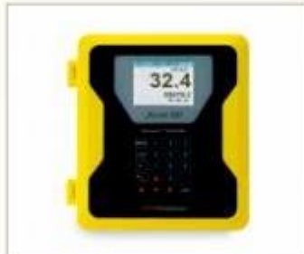
초음파의 전달시간차로 발생된 유속 및 유량을 구하고, 이를 적산하는 변환기
